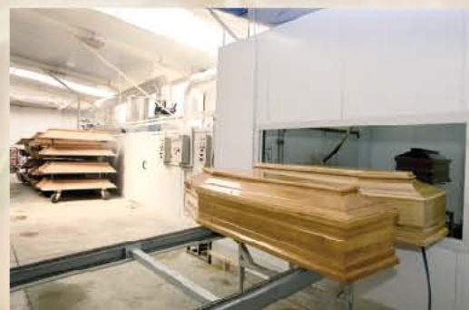
A felületkezelés szárítólagutakban történik
