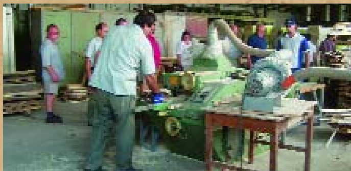
Egylapú szélezőkörfűrész munka közben
