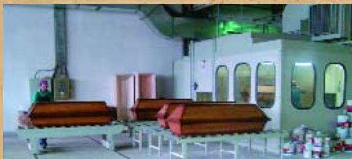
A hamvasztókoporsók lakkozása pormentes fülkében történik
