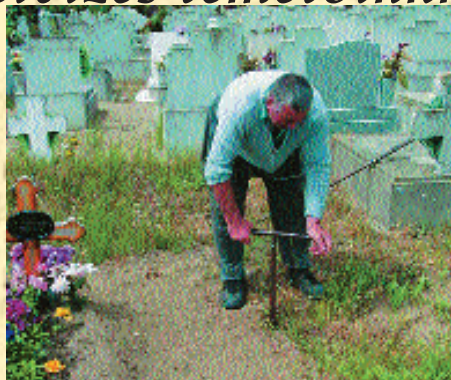
Talajfúrás a zákányszéki temetőben usban például kimérhető volt 1 hét alatti 100 cm-es talajvízszint emelkedés is.
